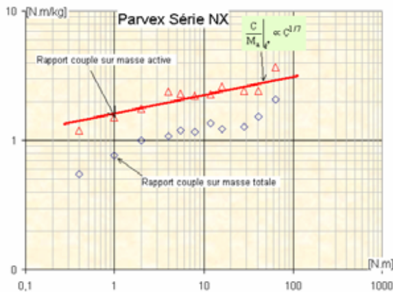
Figure 6. Evolution du couple massique en fonction du couple des moteurs de la série NX de Parvex (2p = 10)
