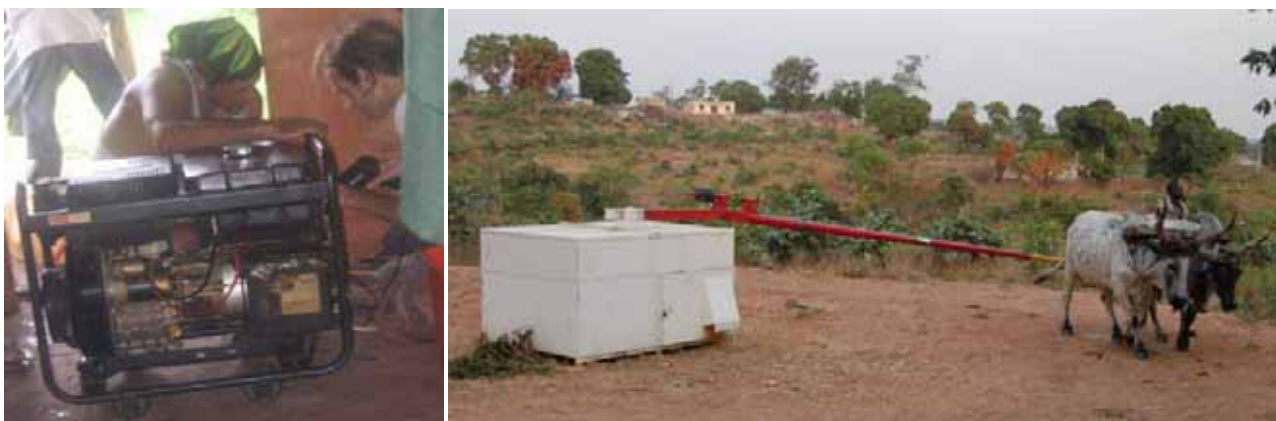
Figure 3 : Le traditionnel groupe électrogène [6] et le générateur « bœuf qui tourne » [4]
