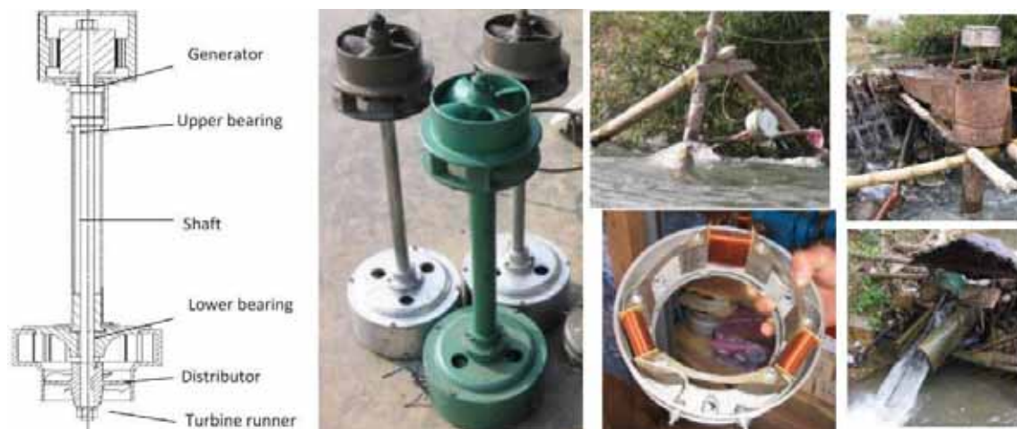
Figure 8 : Pico turbines (100 à 500 W) au Laos : systèmes de basse chute, installations en rivière, génératrice [18]
