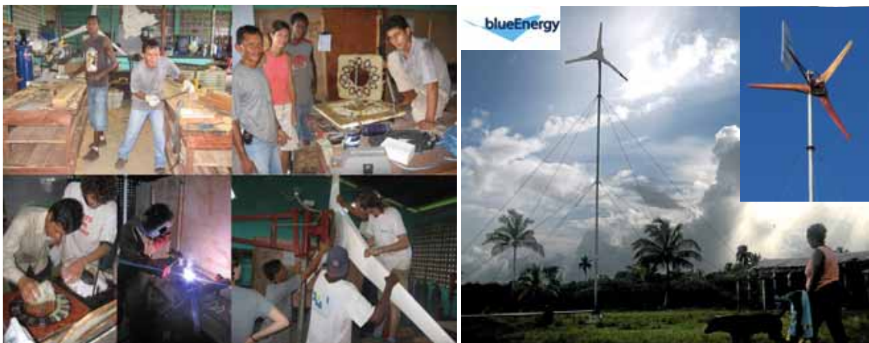
Figure 6 : Fabrication d'une éolienne artisanale au Nicaragua (blueEnergy, extrait du diaporama du master OSE [6])
