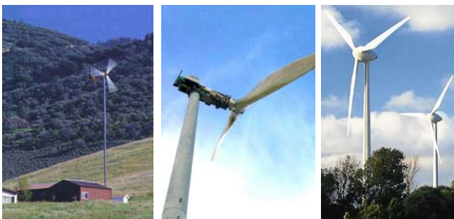
Bergey (US) tripale Excel: 7 m - 10 kW Vergnet bipales Ge220 : 220 kW Enercon tripale E66: 65 m - 1,8 MW
