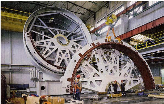
Fig.18- Assemblage de la génératrice de l'E112 d'Enercon (4,5 MW)
