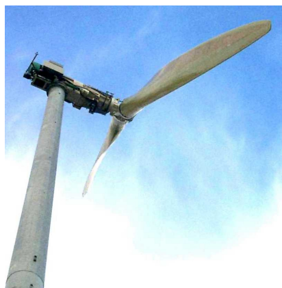
Figure 2.4.3 : Machine à rotor sous le vent : « downwind » bipale Vergnet 220 kW
