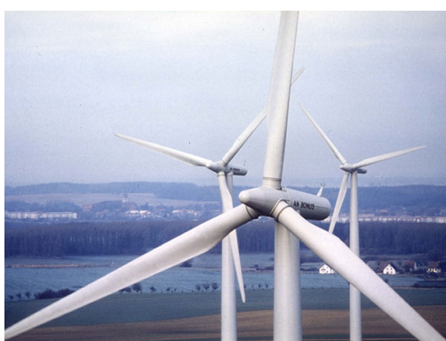
Figure 2.5.7 : Eolienne BONUS 1,3 MW, système de régulation « CombiStall »
