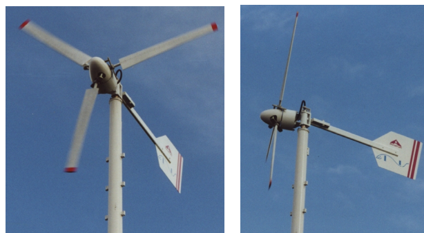
Figure 2.5.9 : Limitation de puissance par déviation horizontale du plan de rotation (effacement latéral). Machines Aircraft 750 W.
