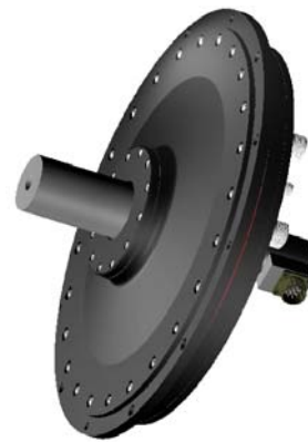
Moteur à aimants Tmax = 1350 N.m Pmax = 35 kW, 58 kg (27 N.m/kg)
