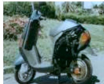
Figure -15- Moteur à champ axial à aimants permanents pour scooter (Université de Rome)
