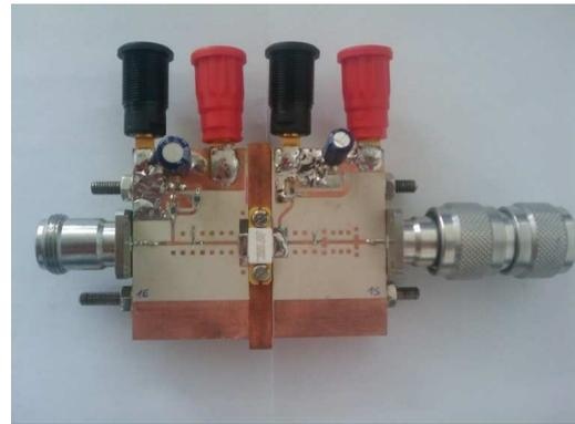
**Figure 2. Amplificateur de test.**
