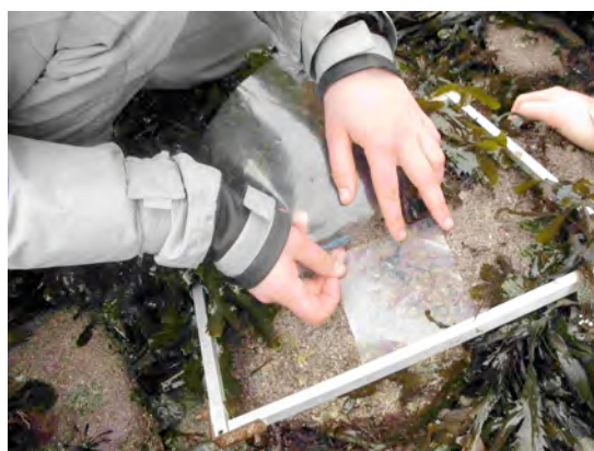
Figure 5 : évaluation des surfaces de recouvrement par utilisation d'un carré en plastique transparent (cl. A. Ponsero)
