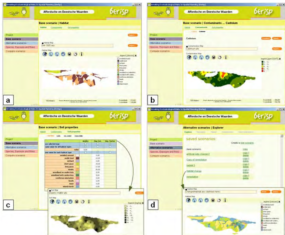
Figure 5. Etude de cas : les différentes étapes pour l'évaluation du risque avec BERISP-DSS. (a) Importation de la carte d'occupation du sol. (b) Importation des données de contamination. (c) Importation des données de propriétés des sols avec les 3 options possibles : une seule valeur pour la zone (pH), une valeur par type d'habitat (teneur en argile) ou un fichier de points géoréférencés qui sera utilisé pour créer une carte par interpolation spatiale (teneur en matière organique). (d) Création de nouveaux scénarii à partir du scénario de base (état actuel), avec ici l'illustration d'un scénario basé sur une nouvelle carte d'occupation du sol.
