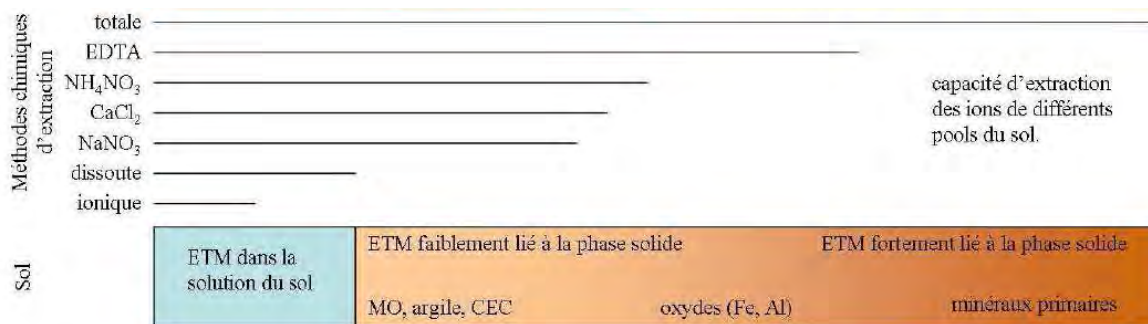
Figure 3 - Capacité de différents extractants chimiques à extraire les ions des différents pools de métaux (ETM, élément trace métallique) du sol
