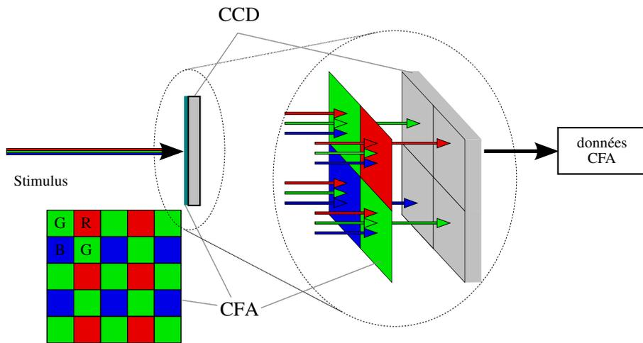
(a) Technologie mono-CCD (schéma simplifié), avec disposition des filtres selon le CFA de Bayer
