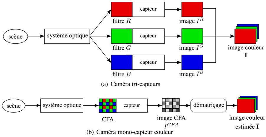
**Figure 6.2.** Acquisition d'une image couleur selon le type de caméra (schémas simplifiés).
