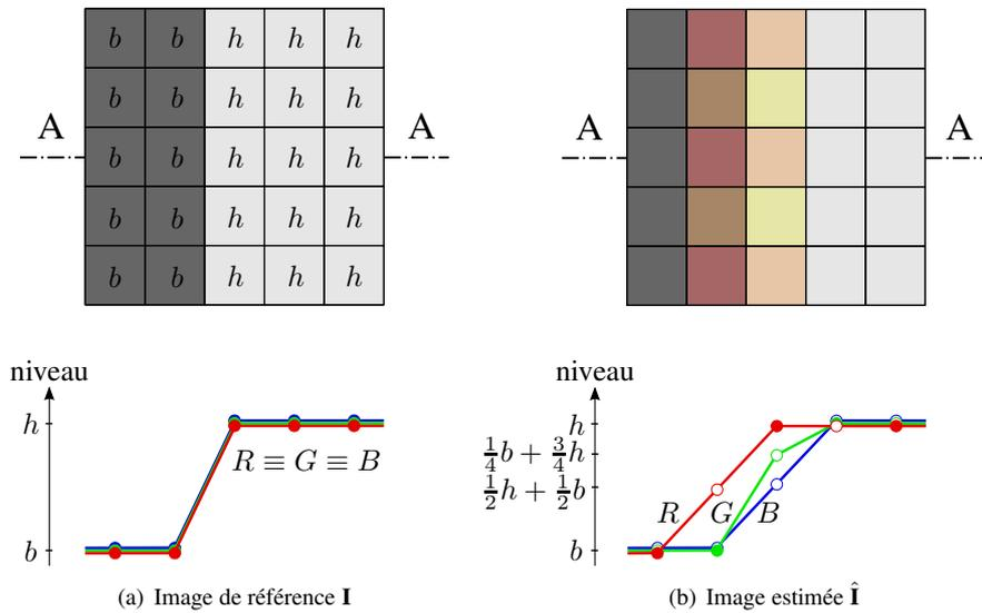
**Figure 6.6.** Images et profils marginaux des niveaux des pixels situés sur la ligne médiane  $A-A$ , pour une image de référence (a) et l'image correspondante estimée par interpolation bilinéaire (b). Dans les profils, les points couleur représentent des niveaux disponibles, les points blancs des niveaux estimés.
