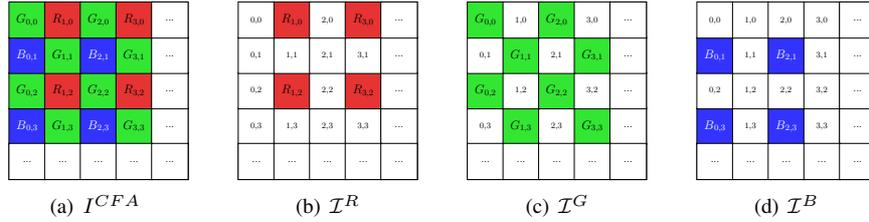
**Figure 6.3.** Image CFA et sous-ensembles de pixels  $\mathcal{I}^k$ ,  $k \in \{R, G, B\}$ . Pour clarifier l'illustration, les pixels sont colorisés avec la composante couleur qui leur est associée.
