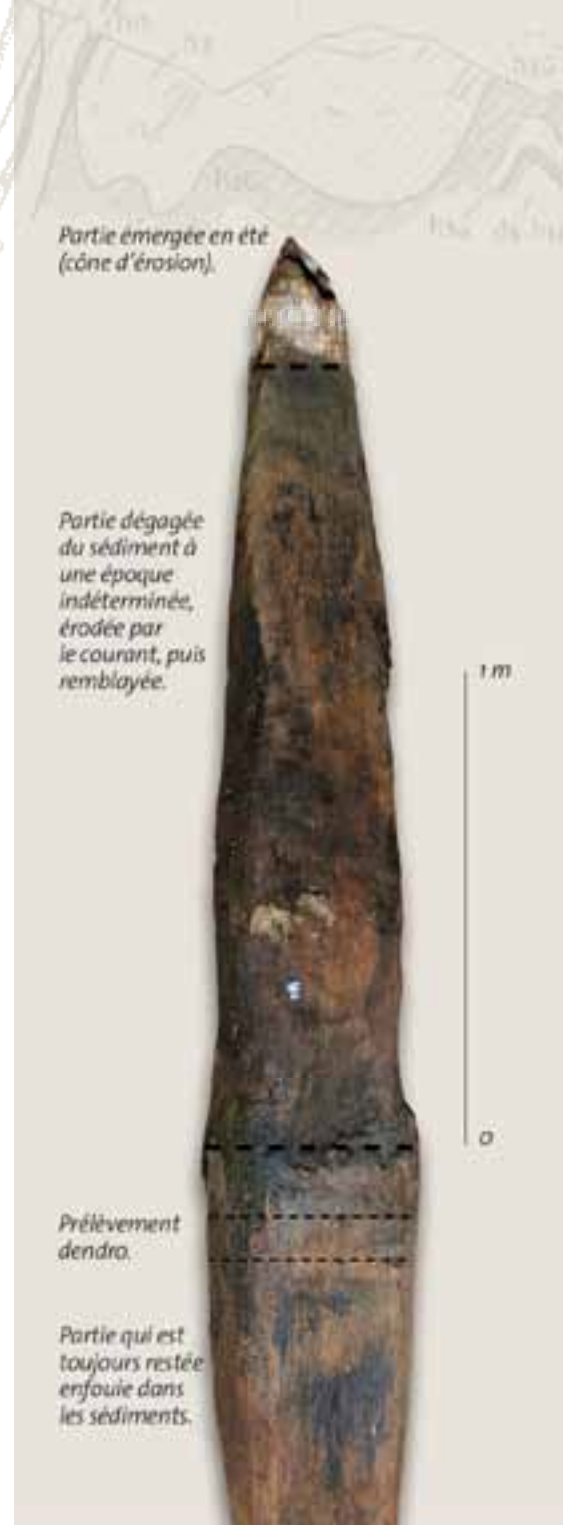
Photo 2 : Le pilot de fondation n° 163 du pont mixte de Saint-Satur : l'extrémité qui émergeait en période de basses eaux présente les signes d'une importante érosion. La partie médiane est également érodée ; seule la pointe est intacte. Si l'on avait prélevé des échantillons pour analyse dendrochronologique dans la seule partie accessible (cône d'érosion), on n'aurait disposé que de la moitié des cernes.
