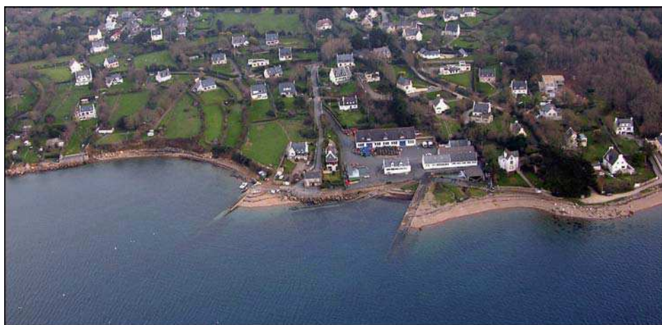
Figure 59 : Cales de Keralliou sur les rives de l'Elorn, illustrant l'effet de blocage du transit sédimentaire par les ouvrages transversaux (cliché : Solen Le Berre, Louis Brigand, 22/02/05).
