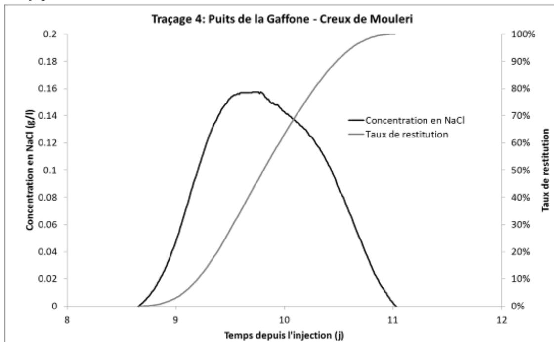
Figure 6 : courbe de restitution du NaCl ajouté au Puits du Creux de Mouleri
