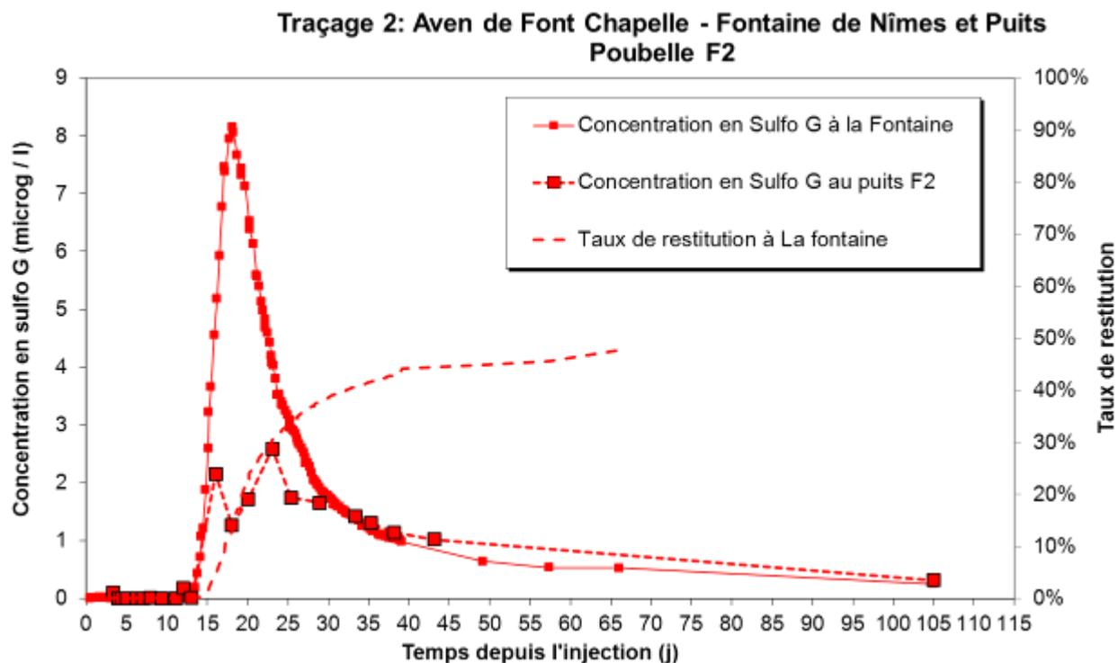
Figure 4 : courbes de restitution de sulforhodamine G au puits Poubelle et à la Fontaine
