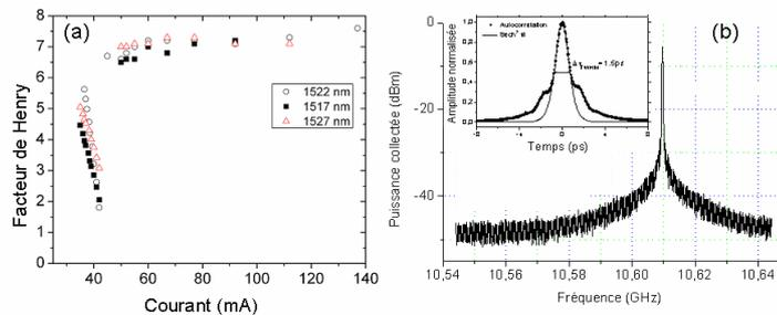
Fig. 3 : (a) facteur de Henry mesuré au-dessus et au-dessous du seuil pour un laser InAs/InP(311)B de longueur 1100  $\mu\text{m}$  et de largeur 3  $\mu\text{m}$ . (b) Spectre RF d'un laser à blocage de modes à 2 sections (section de l'absorbant saturable de 3,2 % de la longueur totale de 4 mm) fonctionnant à 10 GHz (en insert : trace d'auto-corrélation et ajustement)
