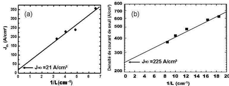
Fig. 2 : Densité de courant de seuil  $J_{th}$  en fonction de l’inverse de la longueur de la cavité à température ambiante, obtenue en mode pulsé. (a)laser 3 plans de boîtes sur InP(311)B (b )laser 5 plans de fils sur substrat InP(100).
