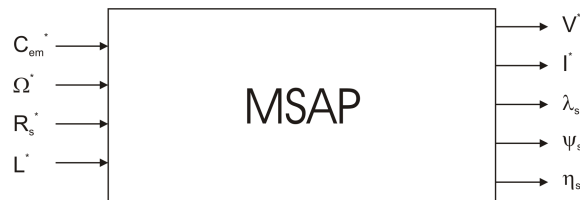
Figure 5. Modèle fonctionnel de la MSAP
