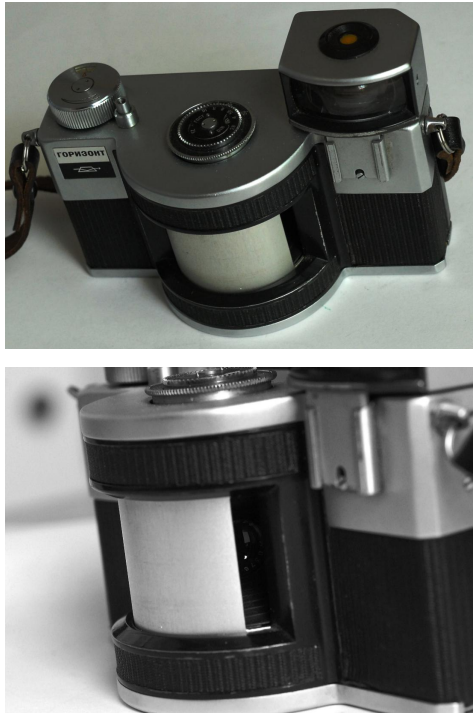
Figure 2 - L'un des ancêtres de la prise de vue cylindrique: Horizont panoramique 24x58. Le film est enroulé sur un cylindre dont l'axe est l'axe de rotation de l'objectif, un simple 2.8/28 mm qui n'est pas optiquement un grand-angle car sa diagonale de champ est seulement 24 mm.
