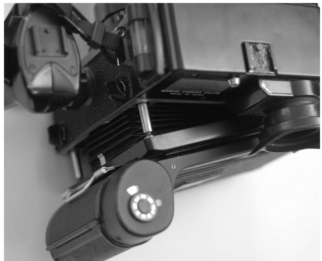
Figure 13 - "Mini chambre" photographique Mamiyapress avec bascule du dos à soufflet à 3 degrés de liberté: une bascule pure sans décentrement , contrairement aux mécanismes de bascule souvent placés dans l'objectif. Plus utile pour les applications en vision, il existe un adaptateur à bascule destiné au système Micro-Four-Thirds.
