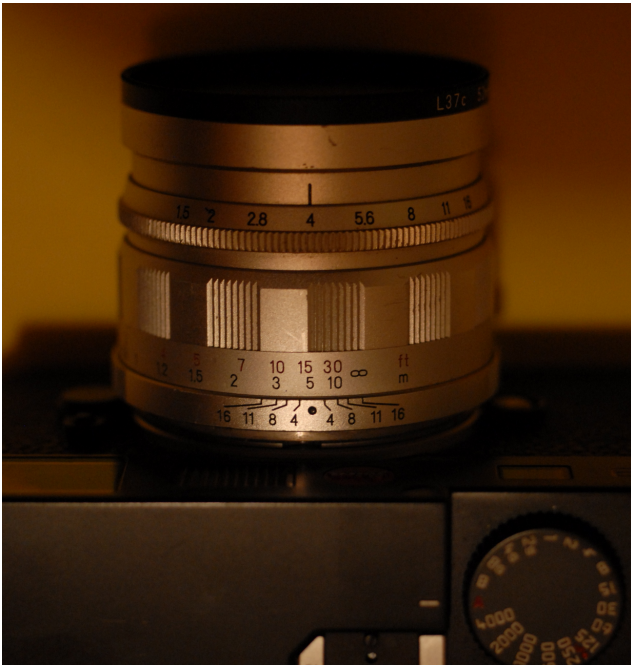
Figure 1 - Graduations de profondeur de champ sur un Voigtlander Nokton 1.5/50. On remarque sur l'objectif: les graduations de diaphragme (en haut: 2.8; 4; 5.6; 8 etc. en puissances de \sqrt{2} ; les graduations de distance (au milieu: 1.5; 2; 3; 5; 10; \infty ) et celles de profondeur de champ (les traits disposés symétriquement).
