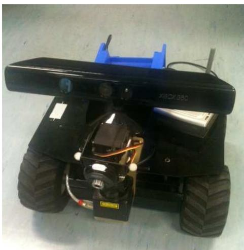
Figure 6 : Le robot Thumblar embarquant une Kinect.
