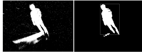
Figure 6 – les résultats d'extraction de fond en présence de l'ombre. (a) premier plan obtenu avec MOG originale. (b) premier plan obtenue avec notre approche.
