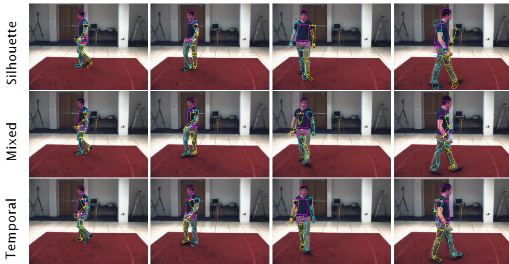
FIGURE 7 – Résultats du suivi pour la séquence S2/C1. Trois différentes méthodes sont comparées (figure 6) : fonction de vraisemblance basée seulement sur les silhouettes (première rangée) , fonction de vraisemblance mixte combinant silhouettes et modèle d'apparence (rangée centrale) et un suivi utilisant de plus le modèle de mouvement proposé (troisième rangée).
