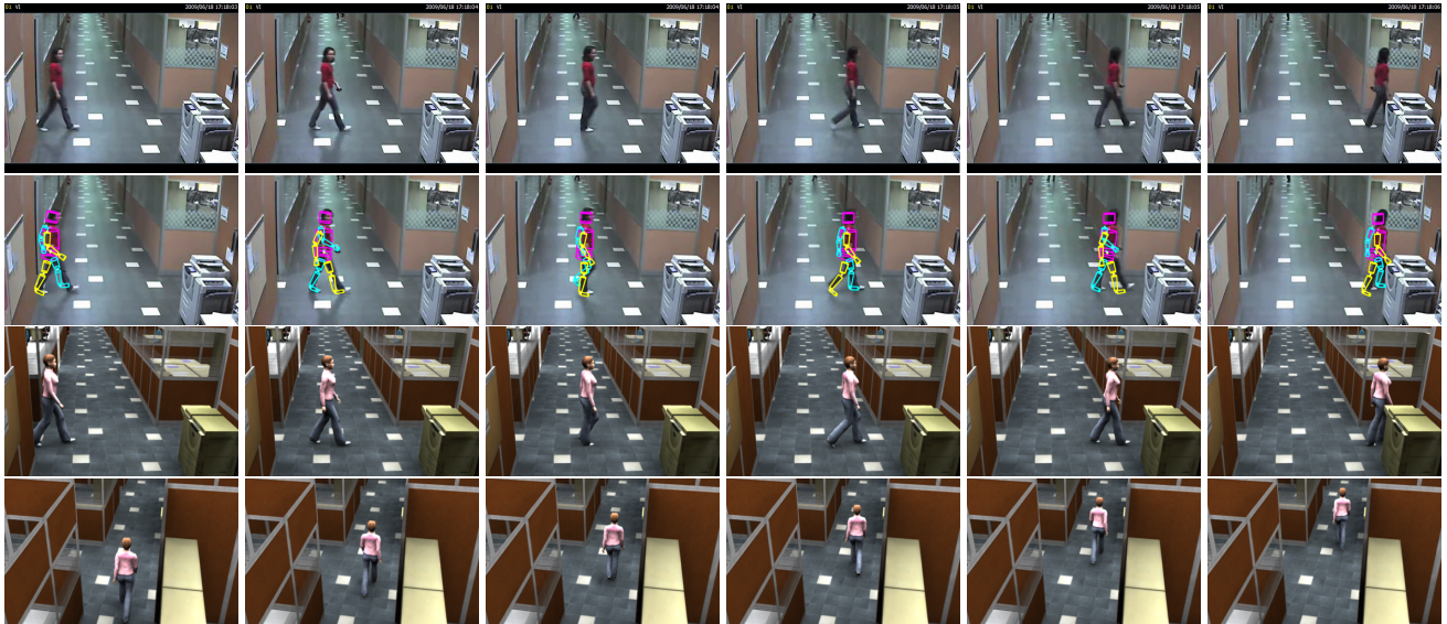
FIGURE 8 – Virtualisation 3D d'une scène dynamique filmée par une caméra de surveillance. Première ligne : des images extraites de la séquence. Deuxième rangée : résultat du suivi 3D projeté sur les images. 3 e et 4 e lignes : animation d'un modèle humanoïde réaliste moyennant le résultat du suivi.
