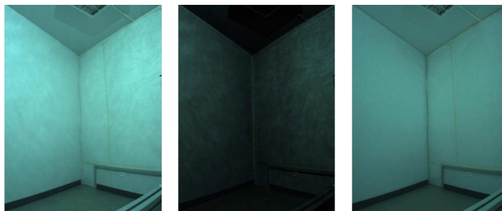
Figure 1: Gauche : scène réelle visible lors de la projection immersive par l'avant d'une image blanche. Milieu : éclairage réfléchi directement, du projecteur vers la caméra, correspondant. Droite : éclairage réfléchi indirectement, après réflexions multiples, correspondant.
