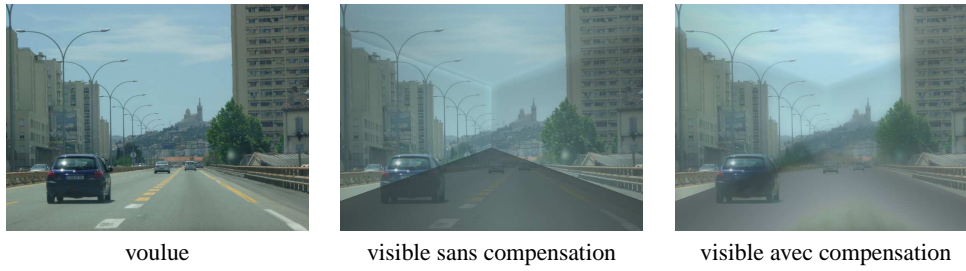
Figure 12: Résultat de la projection et de la compensation sur une surface plus petite de la pièce.
