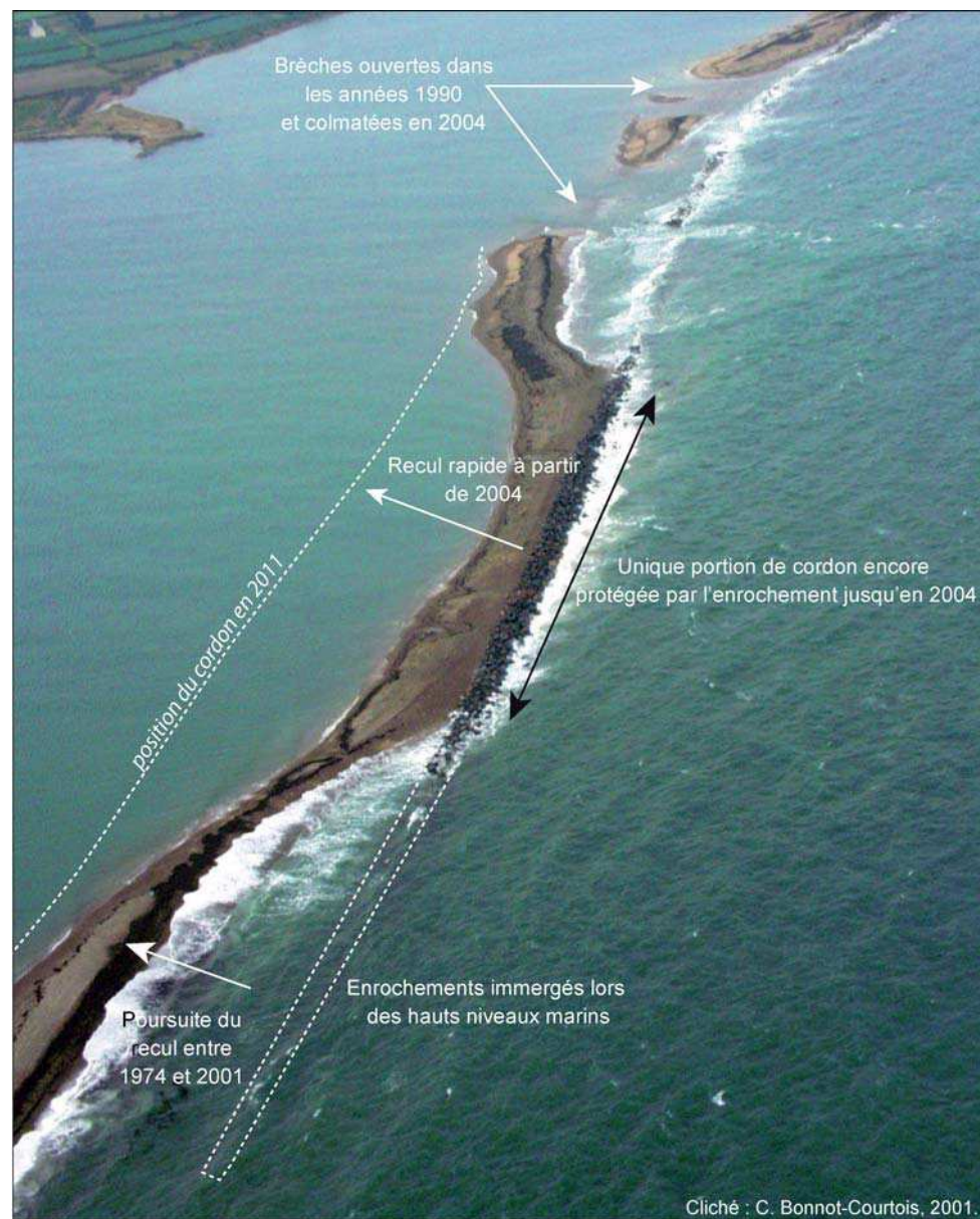
Figure 10 : Vue aérienne d'une partie du Sillon de Talbert lors d'une tempête en septembre 2001.
