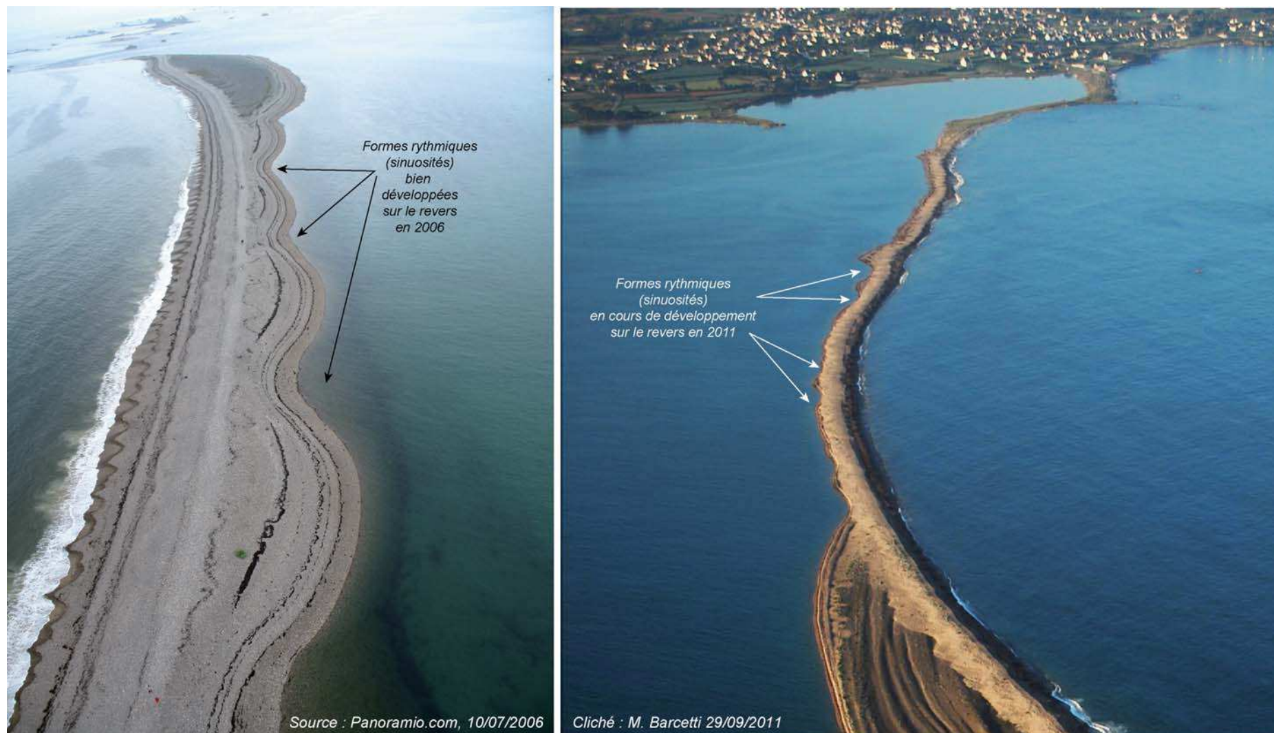
Figure 12 : Formes rythmiques se développant sur le revers du Sillon de Talbert, dans la partie médiane soumise à un transit sédimentaire dirigé vers le sud-ouest. En 2006 (cliché de gauche), ces formes sont bien développées et favoriseront l'ouverture de brèches dans la crête lors des tempêtes de l'hiver 2006-2007. En mars 2008, la tempête Johanna fait reculer le cordon et gomme ces formes sur le revers. En 2011, les sinuosités réapparaissent (cliché de droite).
