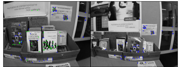
FIGURE 6 – Mise en correspondance des points entre deux images similaires : les points appariés en bleu, les points non appariés en vert sur la vue gauche.
