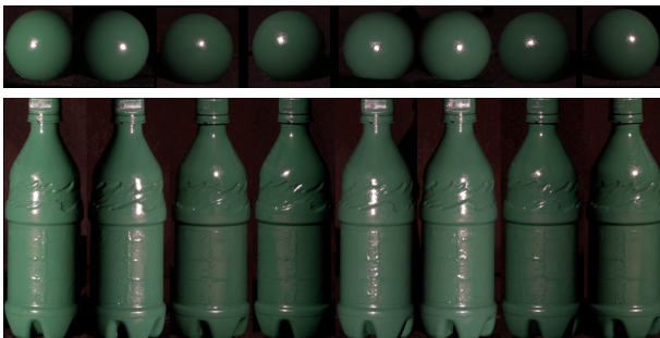
FIGURE 4 – Images réelles d'une sphère (taille 332 \times 328 ) et d'une bouteille (taille 1176 \times 398 ) vues sous n = 8 éclairages différents. Ces images sont accessibles à l'adresse : grail.cs.washington.edu/projects/sam/
