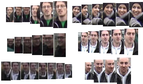
FIGURE 4 – Aperçu des détections de visages de face, obtenues avec l'implémentation OpenCV du détecteur Viola-Jones. La zone de détection est doublée vers le bas.
