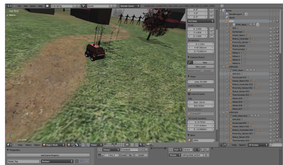
FIGURE 4 – Robot terrestre ATRV développé dans la plateforme de simulation Morse
