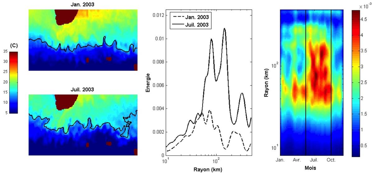
Figure 6: **Analyse multi-échelle de la géométrie des images satellitaires de la température de surface dans la région du courant des aiguilles (Afrique du Sud):** observations de Janvier et Juillet 2003 et lignes de niveaux analysés (zone frontale) (gauche), distributions de la géométrie de ces lignes de niveaux à travers les échelles (de 10km à 500km) (milieu), cycle saisonnier de cette distribution droite).
