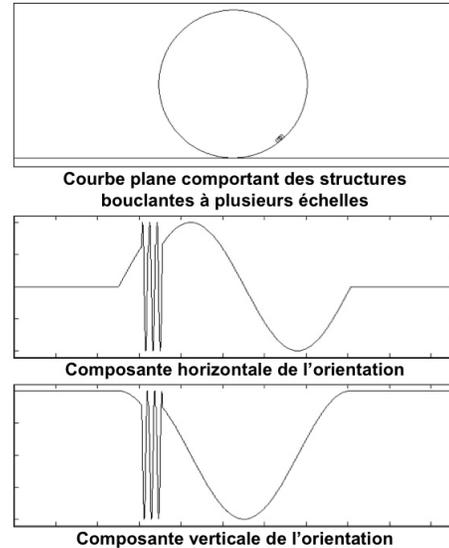
Figure 3: **Principe de l'approche proposée pour la décomposition multi-échelle de la géométrie d'une courbe plane** : courbe plane comportant des structures bouclantes à deux échelles différentes (haut). La série de l'orientation de la tangente à la courbe en fonction de son abscisse curviligne présente une modulation de fréquence directement liée au rayon des boucles.
