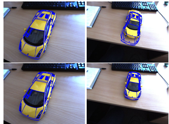
FIGURE 6 – Localisation dans un environnement partiellement connu, composé d’un objet 3D non texturé. En haut : les résultats obtenus avec un suivi basé modèle semblable à celui proposé dans [2]. En bas : les résultats obtenus avec le SLAM séquentiel qui utilise l’algorithme de raffinement LBA_CS&E.
