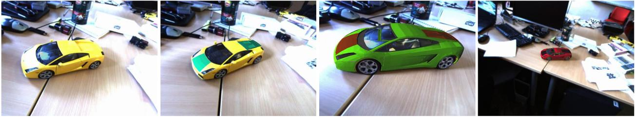
FIGURE 7 – Réalité augmentée sur une voiture miniature non texturée par le SLAM avec l’algorithme de raffinement LBA\_CS&E. De gauche à droite : la voiture avec sa couleur originale et la même augmentée avec différentes couleurs de carrosserie. Notons que seule la carrosserie a été changée, les roues, les fenêtres et le pare-brise sont réels.
