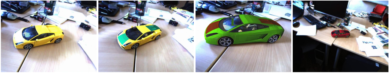
FIGURE 7 – Réalité augmentée sur une voiture miniature non texturée par le SLAM avec l’algorithme de raffinement LBA_CS&E. De gauche à droite : la voiture avec sa couleur originale et la même augmentée avec différentes couleurs de carrosserie. Notons que seule la carrosserie a été changée, les roues, les fenêtres et le pare-brise sont réels.
