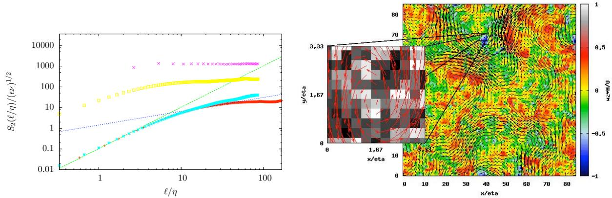
FIGURE 2 – Turbulence de grille. À gauche, Comparaisons de fonctions de structure d’ordre 2. Rouge, mesures fil-chaud ; Turquoise, méthode proposée ; Jaune, approche de [7] ; Fuchsia ; corrélation ; Tiret vert,  $\sim \ell^2$  ; Tiret bleu,  $\sim \ell^{2/3}$ . À droite, champs de vecteurs avec vorticité et images de particules estimés avec la méthode proposée.
