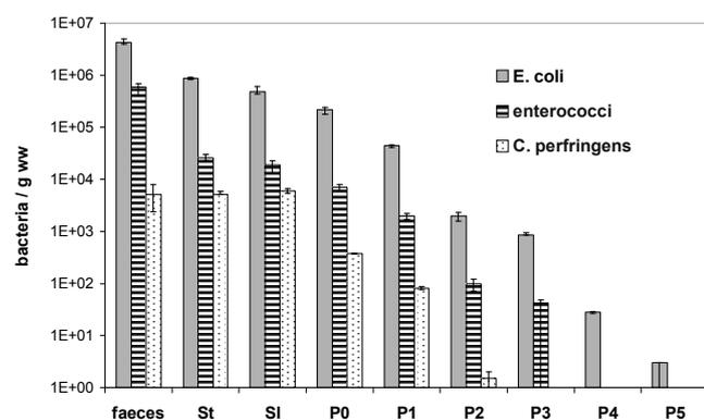
**Figure 3** - Concentrations en *E. coli*, enterococci (décroissance régulière) et *C. perfringens* (diminution dans les filtres plantés surtout) dans le dispositif. Les barres indiquent les valeurs extrêmes (d'après Morand et al., 2009).
