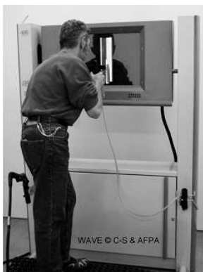
Figure 7: L'apprentissage du geste de soudage. CS WAVE.
