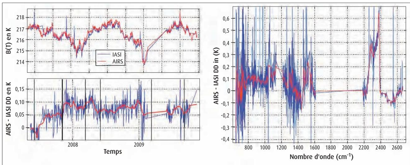
Figure 2 - Interétalonnage de Iasi avec *Airs* aux points de croisement orbitaux. Cette figure montre, en haut à gauche, l'évolution des luminances de Iasi et *Airs* à 698  $\text{cm}^{-1}$  et, en bas à gauche, l'écart entre les deux observations calculé selon la technique de Double différence entre observation et simulation par un modèle :  $\text{Obs-Calcul (Airs)} - \text{Obs-Calcul (Iasi)}$ . À droite, la courbe rouge représente l'écart moyen en fonction du nombre d'onde. (© L. Strow)
