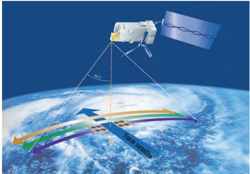
Figure 1 - Géométrie de visée de l'instrument IASI.
