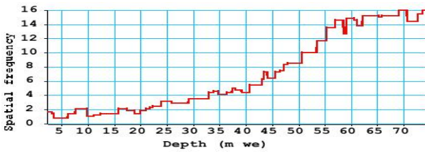
FIGURE 4 – Estimation \hat{f}_s(n) à partir du spectrogramme réalisée sur une fenêtre glissante 128 échantillons après filtrage d'ordre et correction du repliement.
