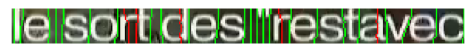
FIGURE 3 – Un exemple de segmentations obtenues : celles « fiables » représentées en vert et celles « risquées » en rouge.
