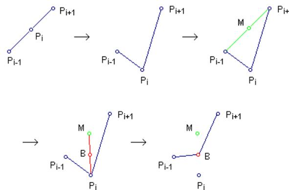
Figure 6 – Technique de lissage du contour
