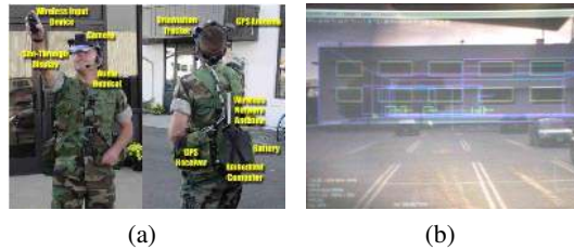
Figure 18. Le prototype BARS testé par un militaire (Julier et al. , 2000) (a) Plate-forme matérielle (b) Exemple d'augmentation
