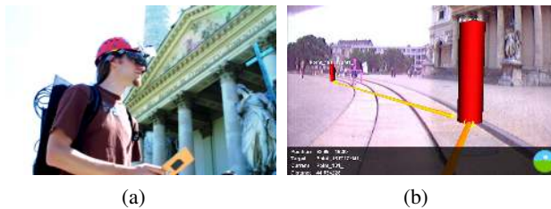
Figure 20. La plate-forme Studierstube (Reitmayr et al. , 2003) (a) La plate-forme matérielle (b) Exemple d'augmentation
