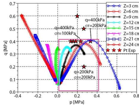
FIG. 2- Chemins de contraintes, dans l'espace ( $p$ , pression moyenne ;  $q$ , déviateur), à différentes profondeurs dans une chaussée sous le passage d'une charge roulante et chargements expérimentaux (étoiles) des essais de fluage à 20°C. (nota : les contraintes et déformations sont positives en compression).
