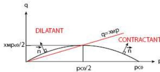
FIG. 6 : Surface de charge de type parabolique
