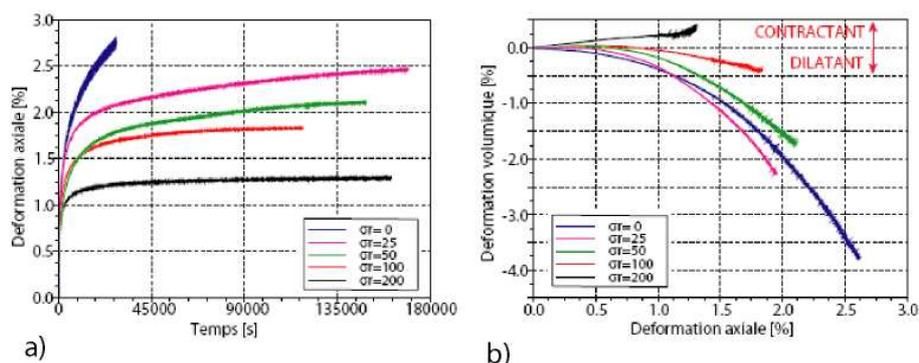
FIG. 4 - Influence du confinement sur la cinétique (a) et la rhéologie du matériau (b). Essais de fluage réalisés à 20°C, pour un déviateur de 400 kPa.
