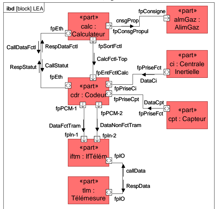
Figure 6 : Diagramme interne de bloc du véhicule LEA
