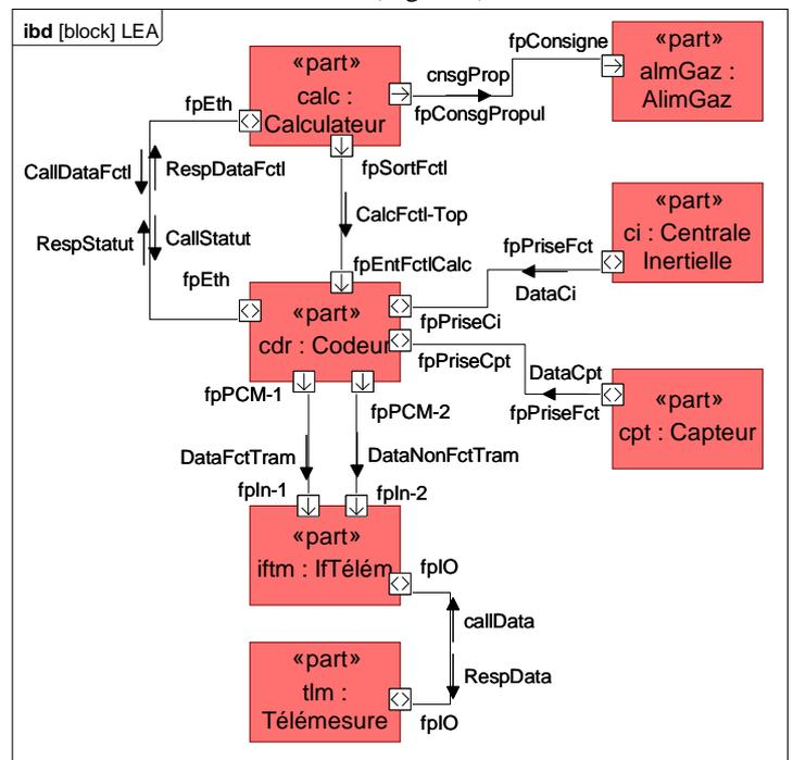
Figure 6 : Diagramme interne de bloc du véhicule LEA
