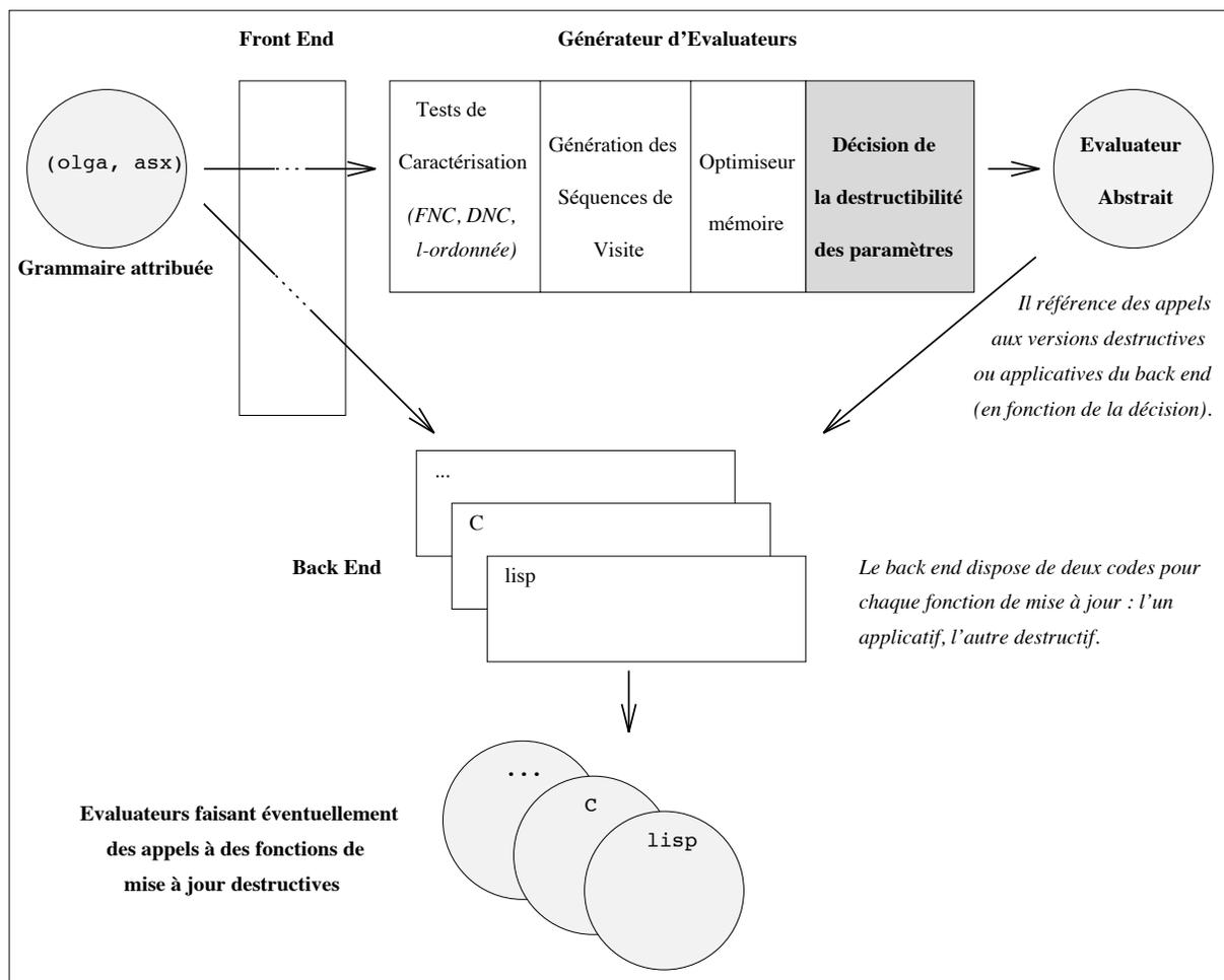
FIG. 7.2 - Mise en place : FNC-2 destructif.
