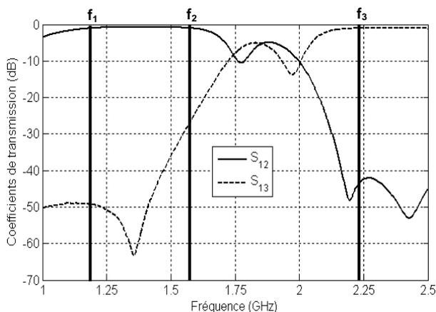
**Figure 3. Coefficients de transmission simulés du diplexeur**
