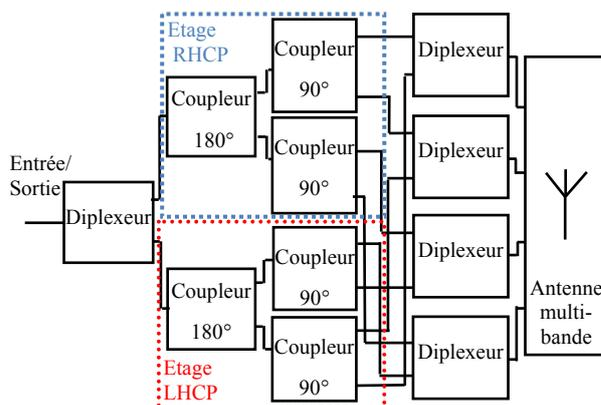
Figure 1. Architecture d'alimentation à diversité de polarisation circulaire
