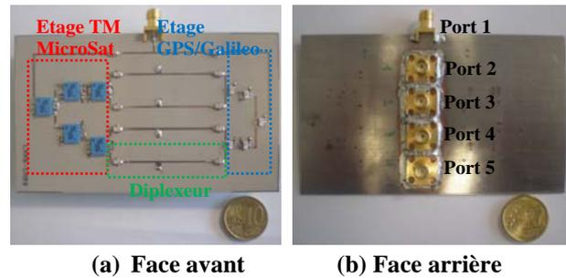
**Figure 4. Photographies du circuit d'alimentation tri-bande réalisé**
