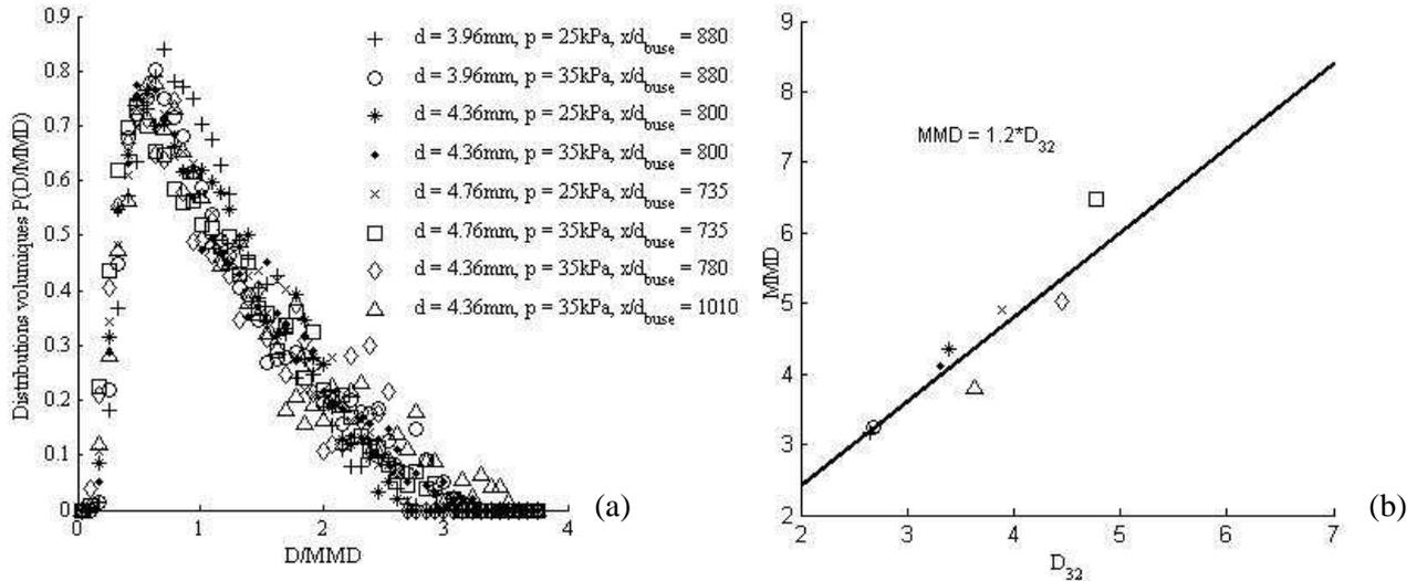
FIG. 3 – Résultats expérimentaux obtenus pour différents nombres de  $We$  et  $Re$ , et différentes abscisses concernant a) les distributions en tailles de gouttes b) le diamètre médian en masse en fonction de diamètre de Sauter (mêmes conditions expérimentales)
