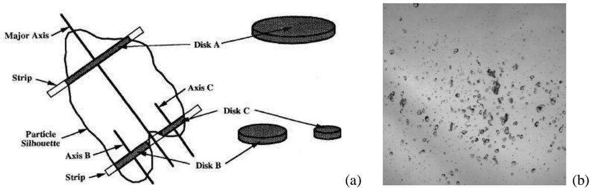
FIG. 1 – a) Découpage d'une particule en tranches cylindriques (Daves et al. [4]) – b) exemple d'images obtenues pour  $d_{\text{buse}} = 3,96\text{mm}$ ,  $P_{\text{inj}} = 2,5\text{ bars}$ ,  $x/d_{\text{buse}} = 880$
