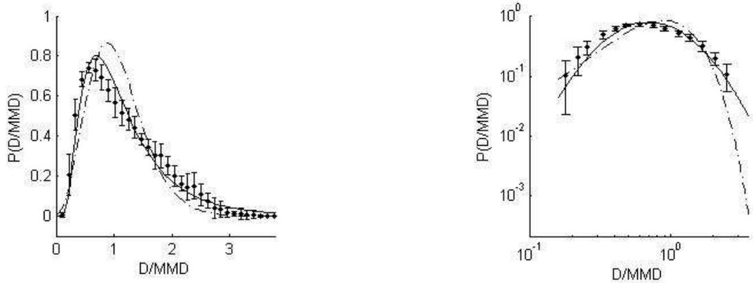
FIG. 4 – Distributions en tailles des gouttes ; les barres d'erreurs représentent l'écart-type et la moyenne, par classe de gouttes, des distributions expérimentales représentées FIG. 3a; trait continu : loi log normale avec  $MMD/D_{32} = 1,2$  ; trait discontinu : loi racine normale de Simmons ( $s = 0,238$ )
