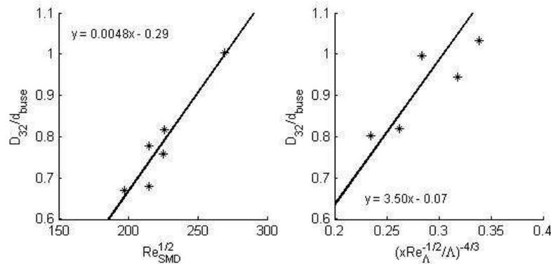
FIG. 5 – Résultats expérimentaux, concernant le rapport  $D_{32}/d_{buse}$ , pour différents  $We$  et  $Re$ , et différentes abscisses;  $x$  et  $SMD$  désignent respectivement la distance à la buse et le diamètre de Sauter ( $D_{32}$ )
