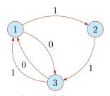
Fig. 1.45.: A synchronized deterministic automaton.
