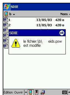
Dans le cas d'une modification l'EIDS nous alerte en précisant le fichier altéré et l'agent accès est lancer pour l'authentification
