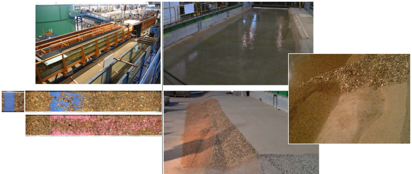
Figure 4 – Modèles physiques en place : à gauche : modèle LWI destiné à analyser le comportement du pavage à l'injection, à droite : modèle EDF destiné à étudier les modalités d'érosion maîtrisée et détail de l'érosion à l'aval d'un épi (site pilote O3).
